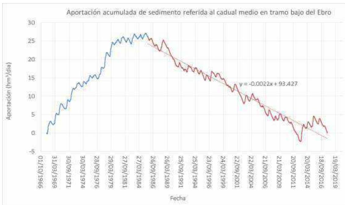
Figura 47. Aportaciones acumuladas de sedimento referidas al caudal medio del curso bajo del río Ebro. Escenario sin embalses. Ajuste del caudal sólido medio del periodo 1986-2016
