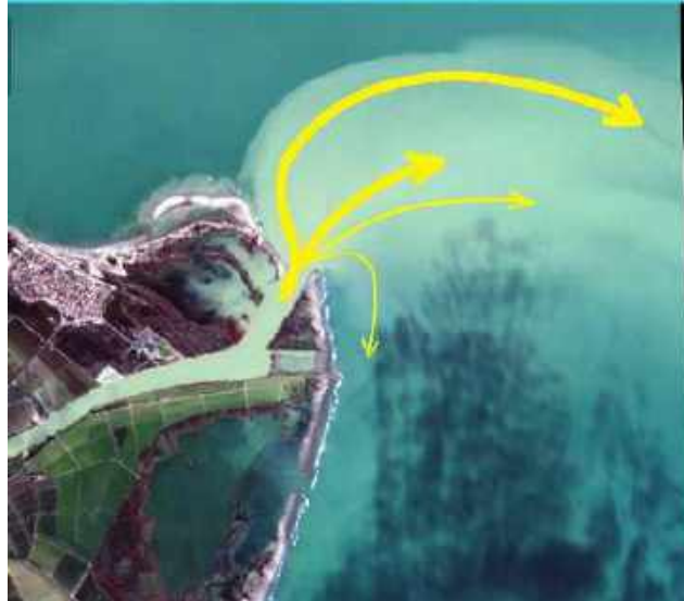
Figura 4.9: Movimientos de sedimento observados en la imagen de satélite del 26 de febrero de 2020, una vez que los expulsa el río Ebro, y su distribución asimétrica espacial (Fuente: ICGC)
