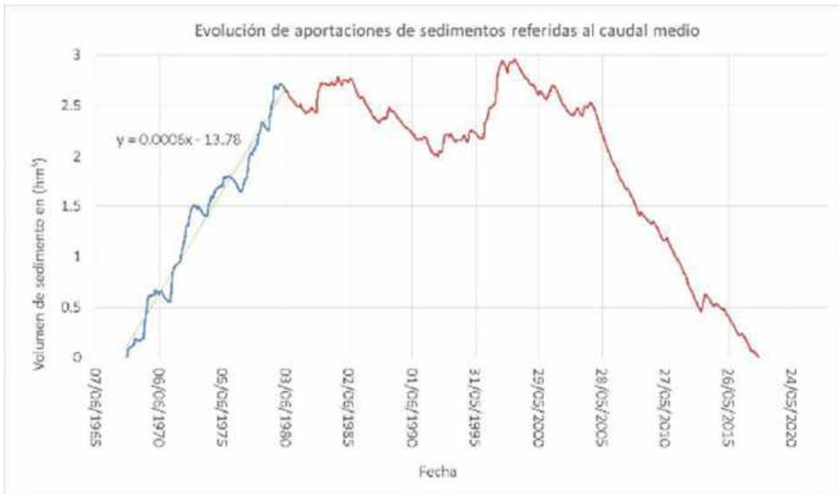
Figura 33. Aportaciones acumuladas de sedimento referidas al caudal medio del curso bajo del río Ebro. Escenario con embalses. Ajuste del caudal sólido medio del periodo 1967-1981
