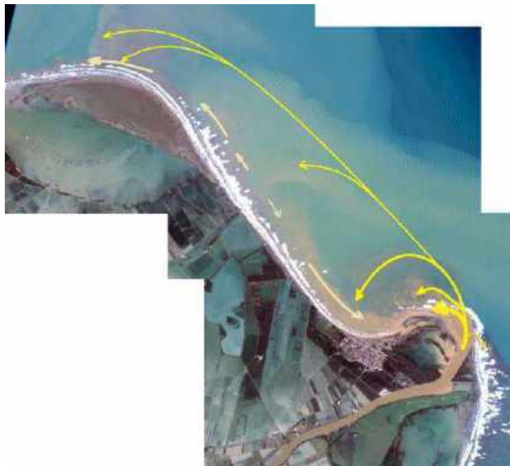
Figura 4. Movimientos de sedimento observados en la imagen de satélite del 23 de febrero de 2020, una vez que los expulsa el río Ebro, y su distribución asimétrica espacial (Fuente: ICGC)
