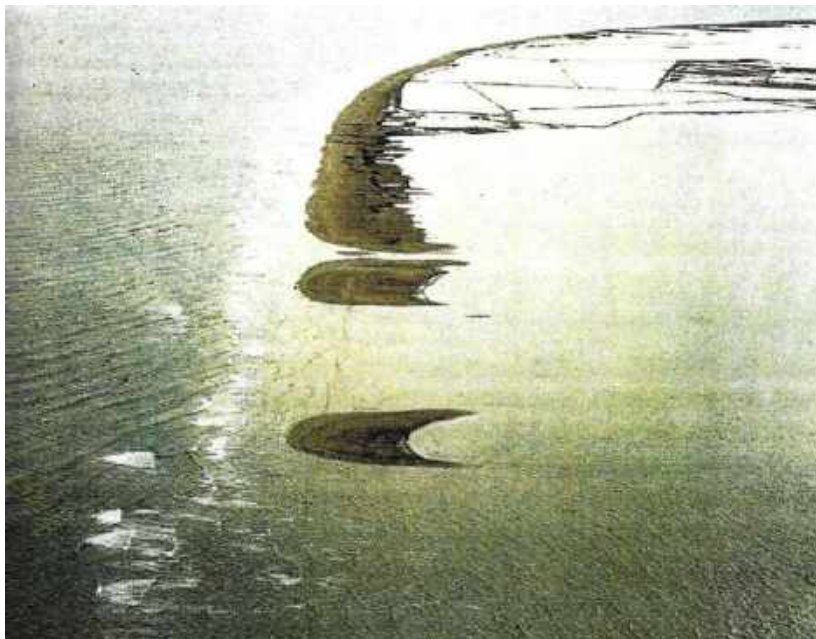
Figura 1.8: Rotura de la Barra del Trabucador en octubre de 1990 (Foto: Montoya y Galofré, 1997)
