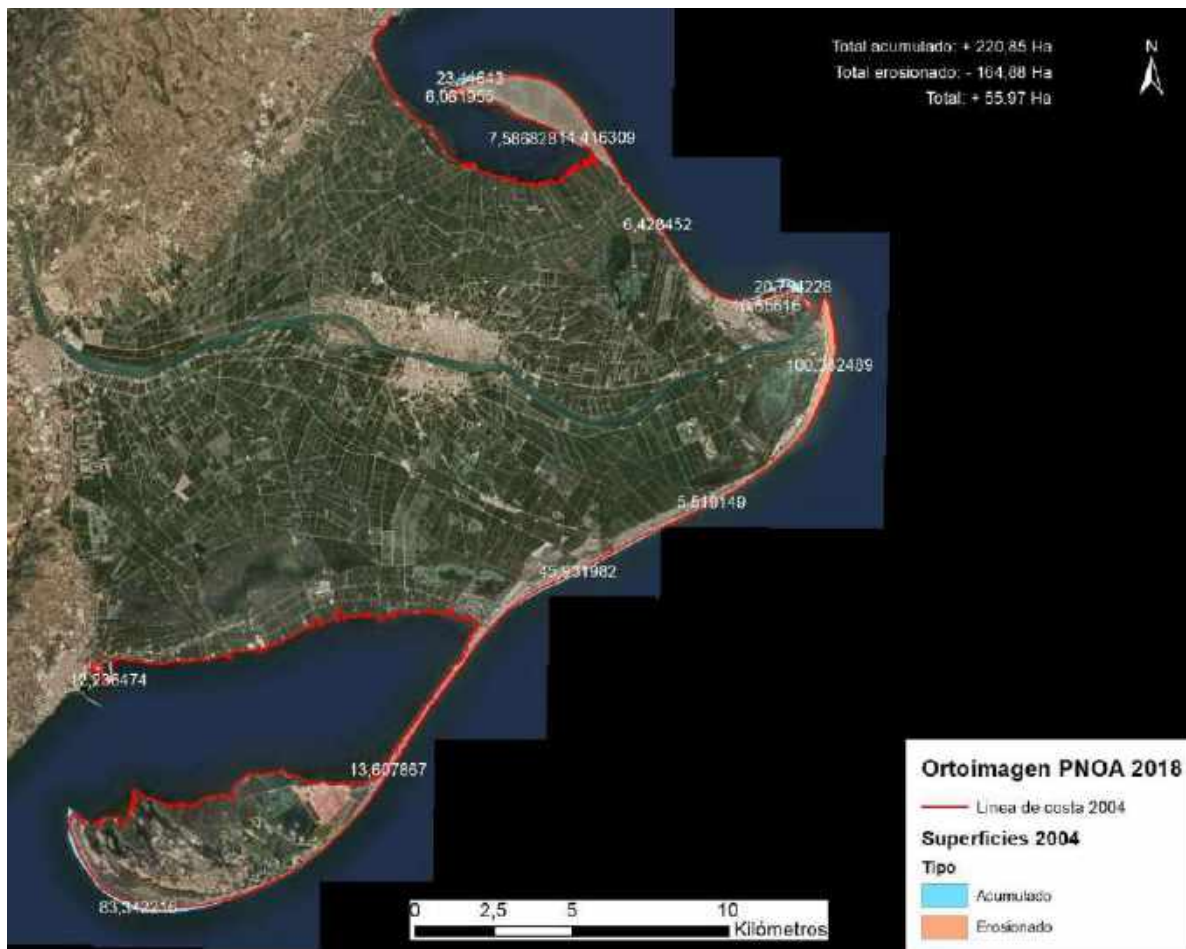
Figura 4.62: Variación de superficie de la costa del Delta del Ebro entre 2004 y 2018 (Ortoimagen: IGN)
