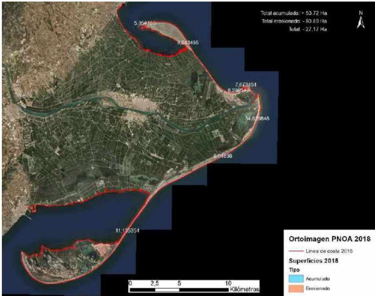
Figura 4.63: Variación de superficie de la costa del Delta del Ebro entre 2015 y 2018 (Ortoimagen: IGN)
