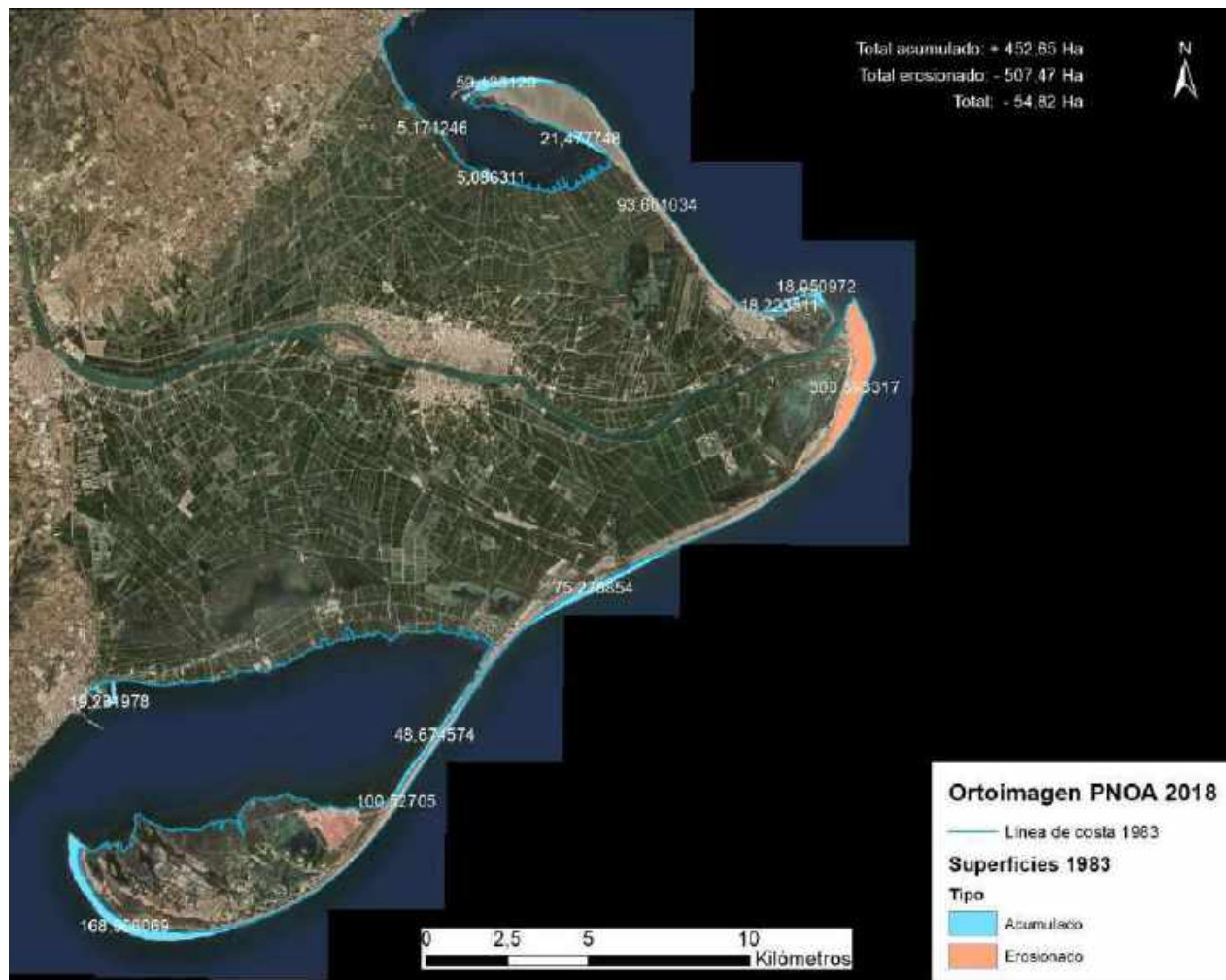
Figura 4.60: Variación de superficie de la costa del Delta del Ebro entre 1983 y 2018 (Ortoimagen: IGN)
