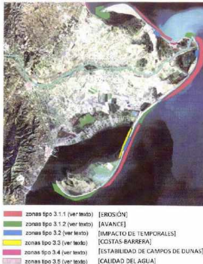
Figura 2.6: Zonificación de las costas del Delta del Ebro según los procesos que dominan (Fuente: LIM y U. Barcelona, 2000)
